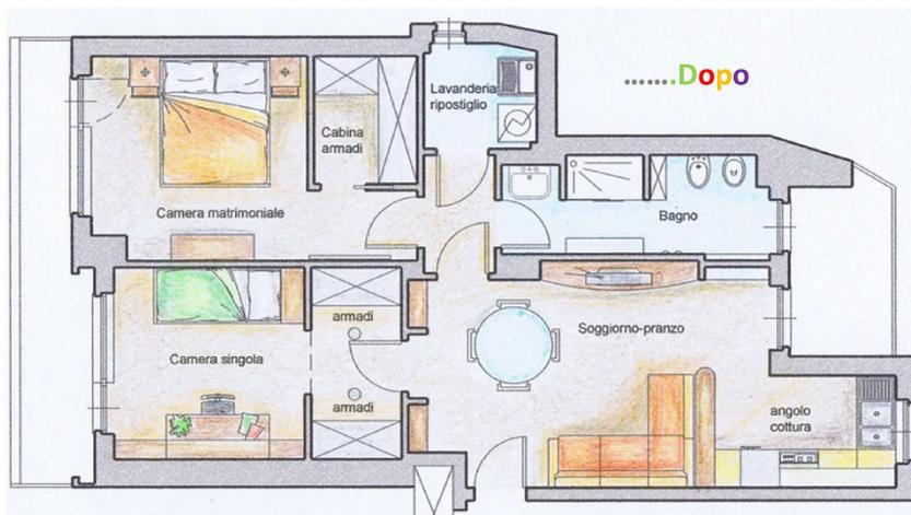
Innanzitutto abbiamo eliminato il muro tra il soggiorno e il corridoio per ampliare il più possibile la zona giorno. La nicchia esistente è stata messa più in evidenza delimitandola con una spalletta in cartongesso e quindi sfruttata per creare un mobile per la TV realizzato «su misura»; sono state inoltre posizionate alcune mensole «porta oggetti» nella zona adiacente la porta-finestra e ricavate 2 librerie sul muro a confine con la camera da letto.
