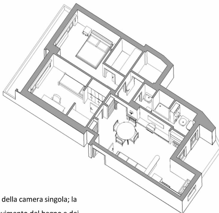
Si prevede la demolizione di un muro e lo spostamento della porta della camera singola; la realizzazione di alcuni divisori in cartongesso, la sostituzione del pavimento del bagno e dei sanitari con l'inserimento della nuova doccia. Alcune modifiche saranno effettuate all'impianto idrico-sanitario sia in bagno che in cucina e a quello elettrico. Per queste opere si prevede una spesa di circa 18.000 Euro
